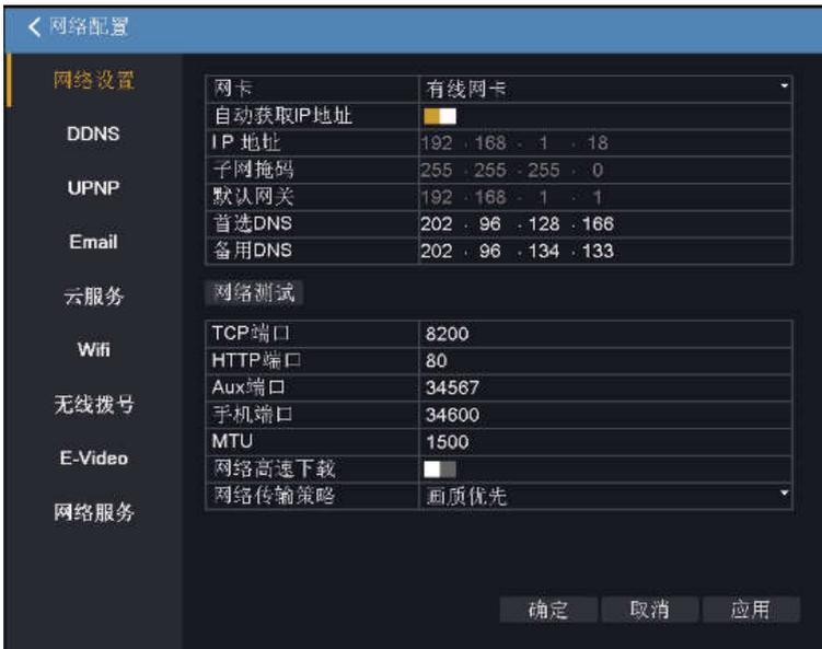
需要将设备的 IP 地址设置为与路由器在同一个网段内，如路由器的 IP 地址为 192.168.90.1, 子网掩码为 255.255.255.0, 则按默认设置即可，一般默认网关就是路由器的 IP 地址。在 IE 中输入设备 IP 即可实现局域网内访问设备。
