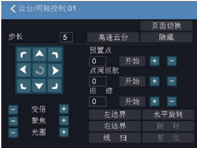
图12.1 云台/同轴控制界面
